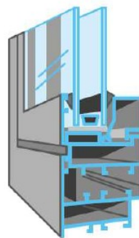
Sense trencament del pont tèrmic
